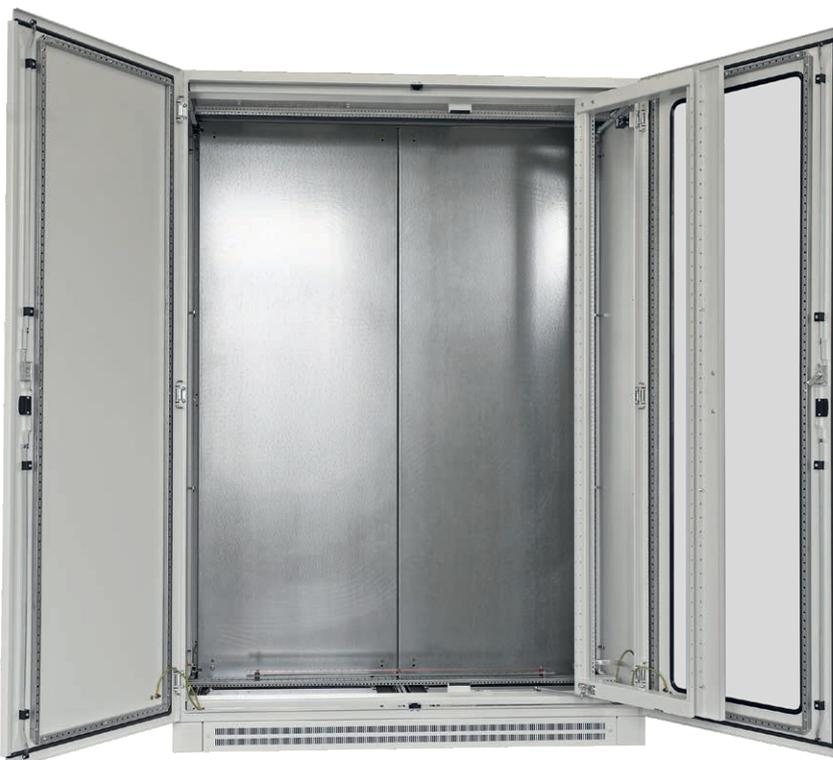
Schrank SZE2 mit einer Breite von 1600 mm inkl. einer zweiteiligen Montageplatte, einem Schwenkrahmen und symmetrischen Zweiflügeltüren
