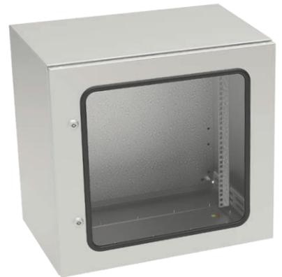
Wandgehäuse SWN IP65 mit einer Montageplatte und 19"-Profilschienen, pulverbeschichtet in RAL 7035. Ausenabmessungen: Höhe 575 mm, Breite 600 mm, Tiefe 400 mm. Nutzhöhe 12 HE. Ausführungen mit einer Blechtür oder Sichttür
